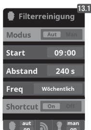
**13.1 Modus Rückspülung mit Besgo-Ventil:** Der DA-GEN ist für die automatische Rückspülung mit Besgo eingerichtet. Konfigurieren Sie das Gerät wie unten beschrieben. Ausgang AUX 2 verwenden!
