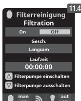
**11.4** Rückspülung: Zur Rückspülung mit einer frequenzgesteuerten Pumpe sollte die schnellste Geschwindigkeit gewählt werden.
