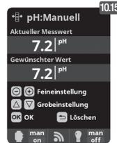
**10.14** Manuelle Kalibrierung: Ermöglicht die Justierung der Sonde (ohne Puffer) – nur empfohlen zum Justieren kleiner Abweichungen der Anzeige.
