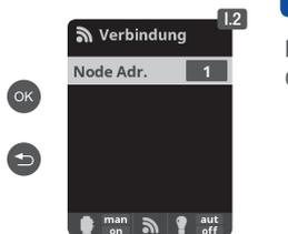
**I.2 Kommunikation (Verbindung):** Dient der Konfiguration von mehr als 2 Userinterfaces. Für einen normalen Betrieb des Gerätes, belassen Sie den Einstellwert des Parameters auf 1.
