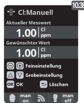
**10.38** Manuelle Kalibrierung: Wasserdurchfluss öffnen und Durchflussmesser (Rotameter) bei korrektem Wert (50-100l/h) fixieren. Auf stabile Anzeige warten. Mit den Tasten **PLUS/MINUS** manuell das Chlor Niveau (manuellen Messer DPD1 verwenden) eingeben. Auf **OK** drücken, sobald der Wert am Display dem gemessenen DPD1 entspricht.
