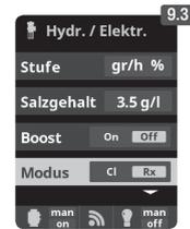
9.3 Modus: Falls Sie über freies Chlor und Redox Sonden verfügen, wählen Sie den Parameter, welcher die Chlorproduktion der Zelle steuert.
