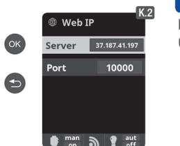
**K.2 Server Steuerung und Verbindungs-Port** im Falle des Anschlusses eines Wifimoduls. Für einen guten Betrieb des Gerätes, verändern Sie nicht die voreingestellten Werte, es sei denn, Ihr Provider fordert Sie dazu auf.
