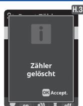
**H.2 Rückstellung Zähler:** Es gibt zwei Levels von Betriebsstundenzähler, welche die Betriebsstunden der Komponenten und Geräte aufzeichnen. In diesem Service-Menü kann der Installateur die Betriebsstundenzähler des ersten Levels zurückstellen (z.B. nach Kauf einer neuen Zelle). Auf das zweiten Level der Betriebsstundenzähler kann nur im Werk zugegriffen werden.
